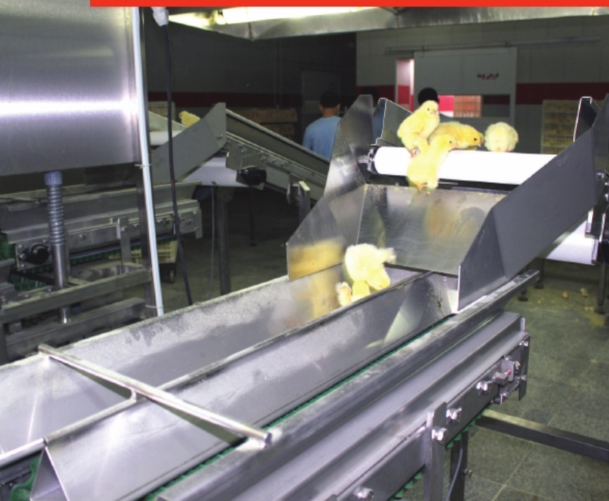
نصب و راه اندازی دستگاه شمارش جوجه "Pas Reform" در کارخانه جوجه کشی ماکیان مهر گنبد
